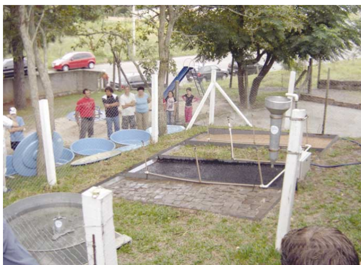
Experimento simulou escoamento de água em quatro tipos de superfície de solo
